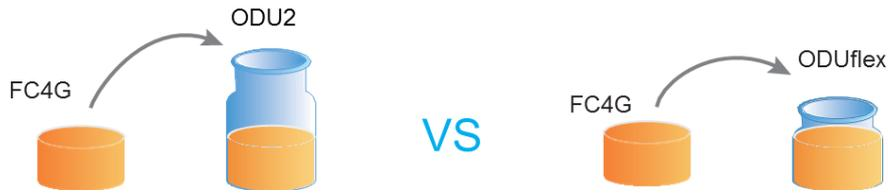
图 28 ODUflex 灵活配置容器容量示意图
