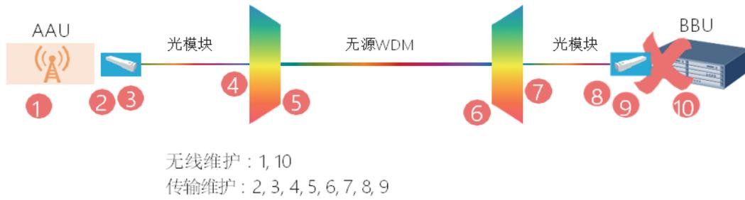
图 14 无源 WDM 方案故障定位示意图
